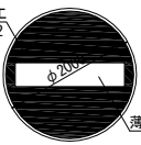
進入禁止路面標示詳細図
